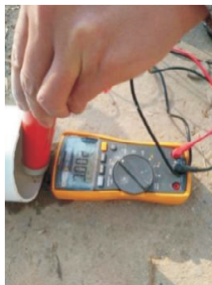
图 2 参比电极在开孔聚乙烯塑料管的电位测试图
